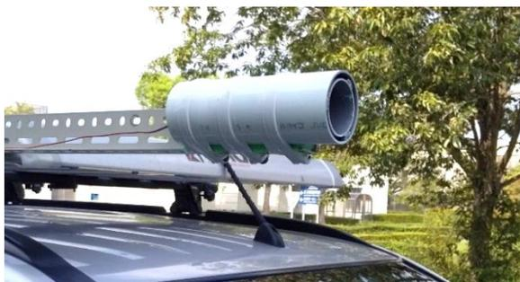
図4. 白色塗装を施した移動観測用通風筒
